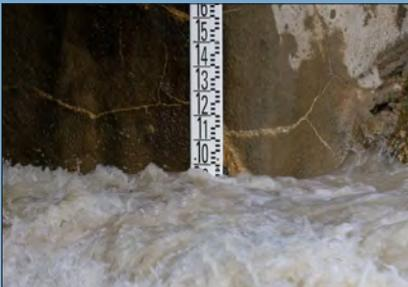
Échelle limnimétrique sur le Grand Buëch
